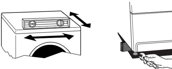
Si la sècheuse n'est pas de niveau, la déposer sur un bloc de bois. Utiliser une clé à molette pour ajuster les pieds vers le haut ou vers le bas, et vérifier à nouveau si elle est de niveau.
