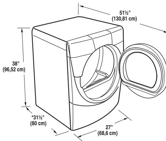
\*La plupart des installations requièrent un espace minimum de 5" (12,7 cm) derrière la sècheuse pour le conduit d'évacuation avec coude. Voir "Exigences concernant l'évacuation".
